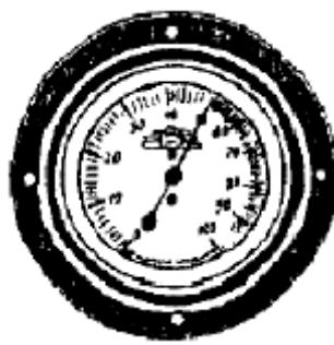
*Рис. 4.* Волосяной гигрометр
