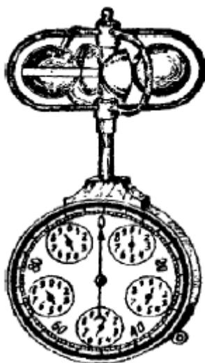
**Рис. 5.** Чашечный анемометр
