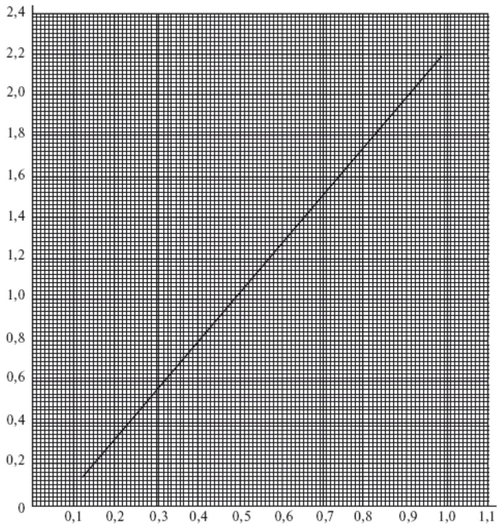
**График зависимости числа делений шкалы в секунду от скорости направленного воздушного потока (от 1 до 5 м/с)**
