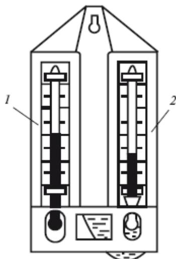
**Рис. 1.** Стационарный психрометр: 1 – сухой термометр, 2 – влажный термометр
