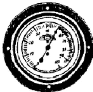
*Рис. 4.* Волосяной гигрометр
