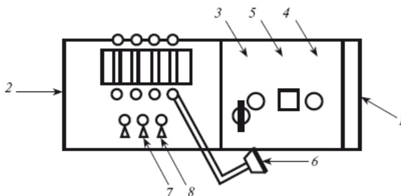
**Рис. 7.** Схема установки ОТ-1: 1 – пылевая камера; 2 – приборный отсек; 3 – бункер-дозатор; 4 – отверстие для отбора пробы; 5 – окно для визуальной оценки запыленности; 6 – аллонж (воронка с фильтром); 7, 8 – ручки управления.
