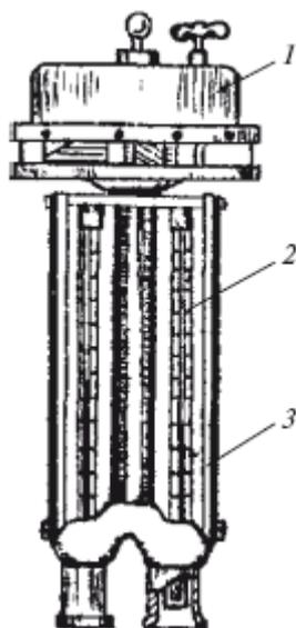
**Рис. 2.** Аспирационный психрометр Ассмана: 1 – головка, 2 – термометр, 3 – трубка защитная
