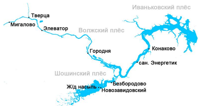
Рис. 1. Схема расположения пунктов отбора проб воды в Иваньковском водохранилище
