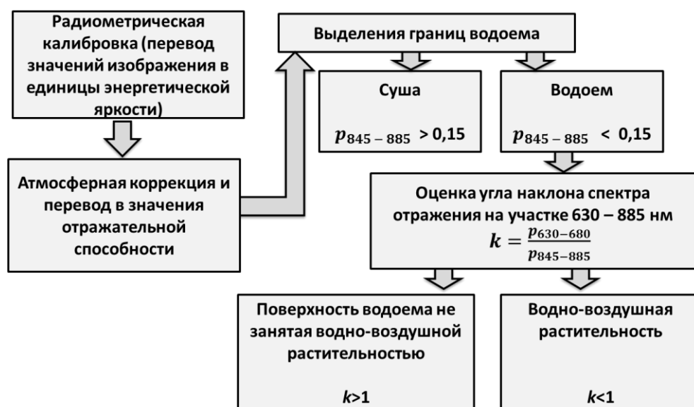
Рис. 14. Блок-схема алгоритма определения береговой линии водного объекта и границ зон распространения воздушно-водной растительности по данным сенсора OLI спутника Landsat-8 в оптическом диапазоне
