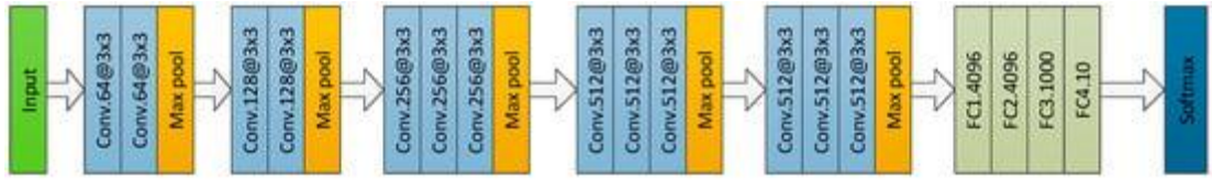
Рисунок 74 — Архитектура ИНС классификации объектов по данным PCA
