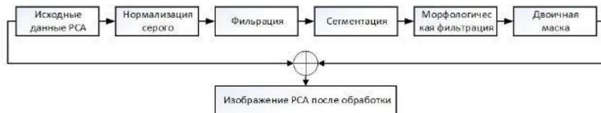
Рисунок 71 — Последовательность предварительной обработки изображений РСА
