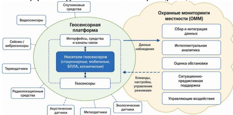
Рисунок 3 – Состав и структура геосенсорной территориально распределенной платформы
