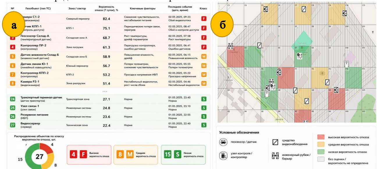
Рисунок 24 – Результат работы программной методики для ЛЦ №1: а – ранжированный перечень ГО для контроля и регулирования тех. готовности; б – геоизображение оценки технического состояния ГО
