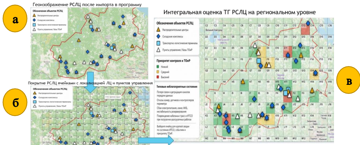
Рисунок 19 – Последовательность перехода к региональному уровню: а – базовая геоподложка РСЛЦ; б – пространственная сетка разбиения РСЛЦ на контролируемые участки; в – оценка обстановки в системе ОММ РСЛЦ на региональном уровне
