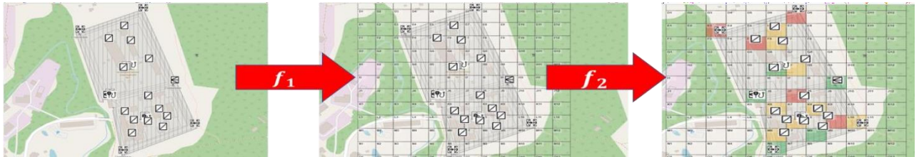
Рисунок 18 – Последовательность перехода к локальному уровню на примере ЛЦ №2: f_1 – отображение базового представления обстановки в ОММ ЛЦ в систему дискретных ячеек; f_2 – отображение системы дискретных ячеек в оценку состояния ТПС ОММ РСЛЦ
