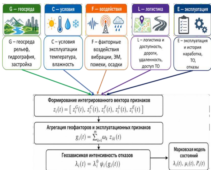
Рисунок 9 – Последовательность формирования геоавтономной интенсивности отказов для матрицы переходов состояний для оценки состояния ОММ
