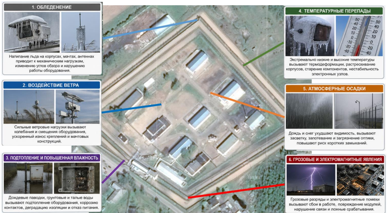
Рисунок 1.9 – Примеры воздействия природно–климатических факторов гоесреды на технические средства ОММ РСЛЦ
