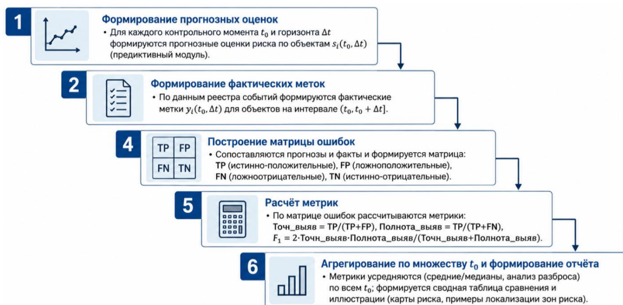
Рисунок 4.18 – Последовательность расчета значений метрик: t_0 – контрольный момент; \Delta t – горизонт прогноза; s_i(t_0, \Delta t) – прогноз угрозы по объекту i ; y_i(t_0, \Delta t) – фактическая метка (1 – неблагоприятное событие наступило, 0 – не наступило);
