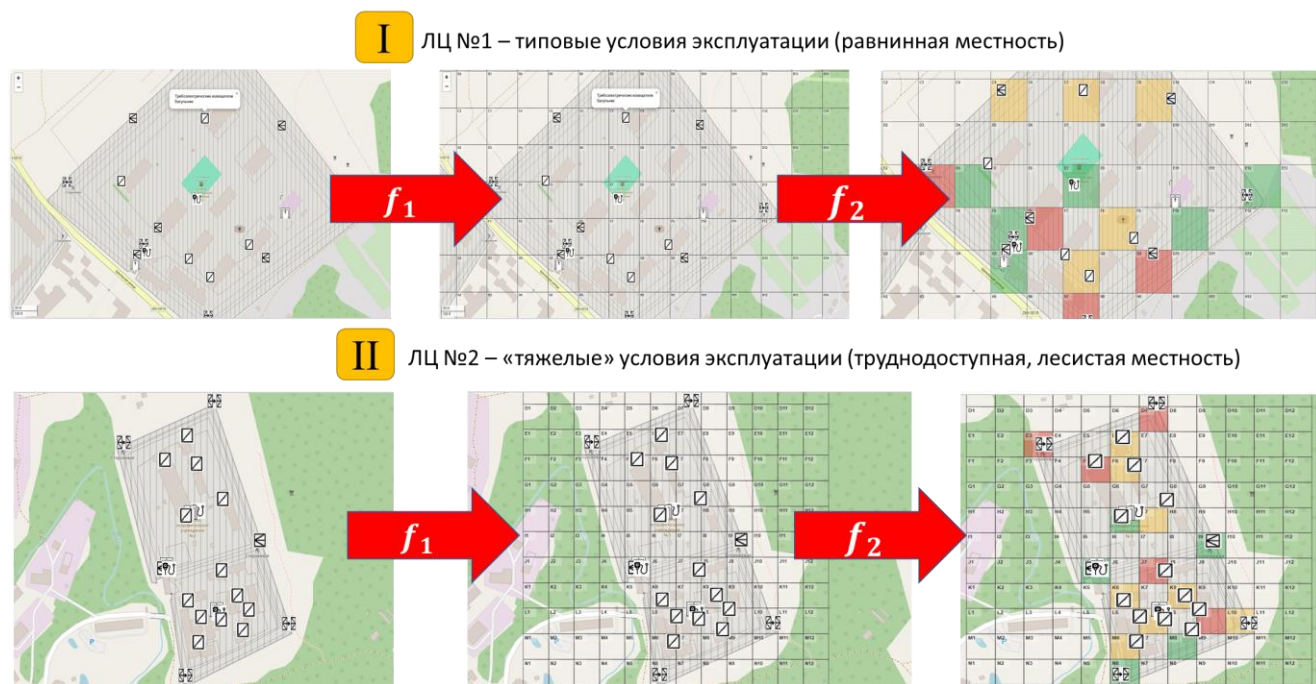
Рисунок 4.11 – Последовательность перехода к локальному уровню на примере ЛЦ №1 и ЛЦ №2: f_1 – отображение базового представления обстановки в ОММ ЛЦ в систему дискретных ячеек; f_2 – отображение системы дискретных ячеек в оценку состояния ТПС ОММ РСЛЦ
