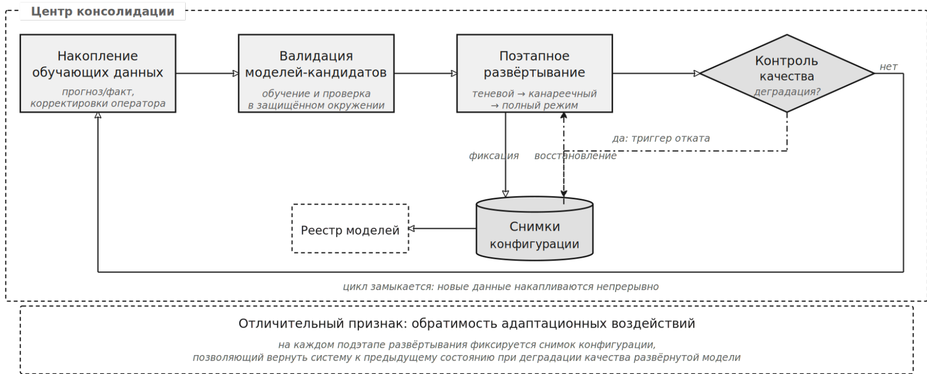
Рисунок Б.3 — Контур непрерывного обучения с обратимостью адаптационных воздействий
